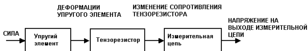
Рис. 1. Структурная схема тензорезисторного датчика силы
