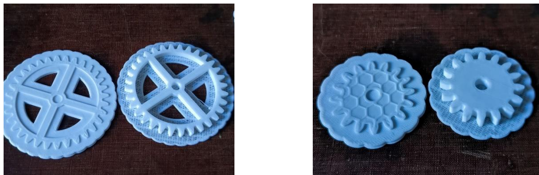
Рис. 4. Сравнение напечатанных зубчатых колёс: а - сравнение высоты слоя подложек ведомого зубчатого колеса; б – сравнение высоты слоя подложек ведущего зубчатого колеса
