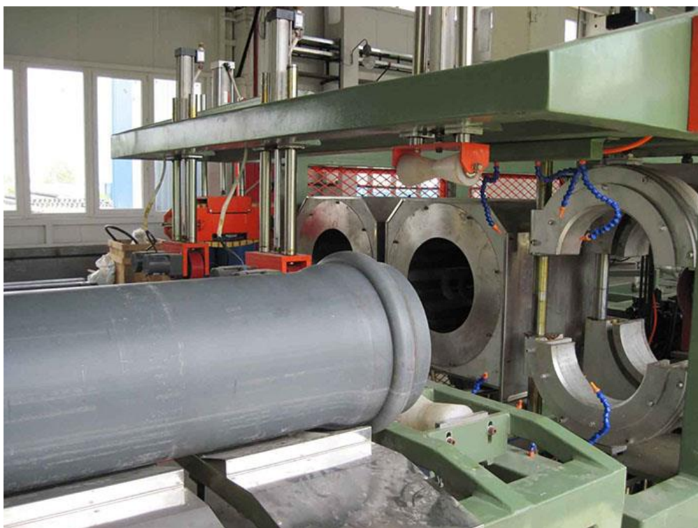
Рис. 2. Экструзионная линия по производству поливинилхлоридных труб [1]
