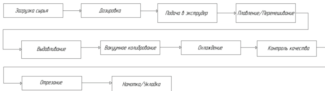
Рис. 3. Последовательность этапов технологического процесса изготовления полимерных труб [3]
