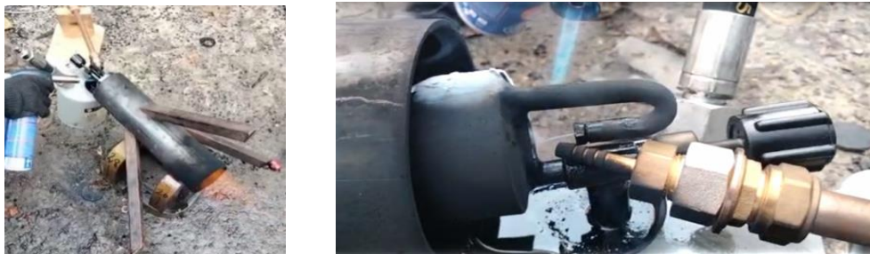
Рис. 2. Схема дополнительного парового диспергирования ДТ (справа) для эффективного распыливания в условиях предварительных испытаний макетной установки (слева – общий вид)
