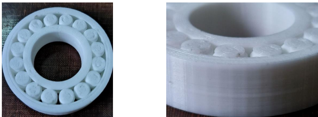
Рис. 7. Роликовый подшипник скольжения: а – общий вид зацепления; б – качество печати подшипника
