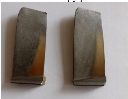
Рис. 2. Результат абразивно-эрозионного износа по перу рабочей поверхности лопатки
