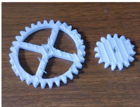
Рис. 5. Модели зубчатых колёс после снятия подложек
