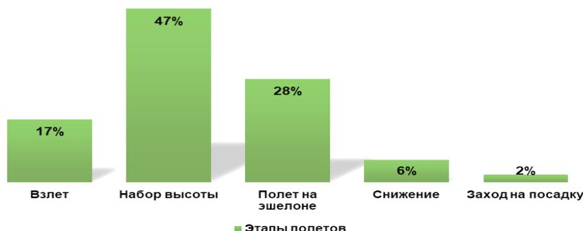
Рис. 3. Распределение отказов лопаток ГТД по этапам полета
