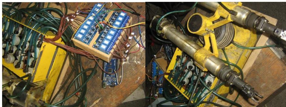
**Рис. 6** Совершенствованный стенд на базе промышленного робота РФ-202М
