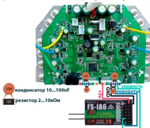
Рис. 4. Плата с радиоприёмником.
