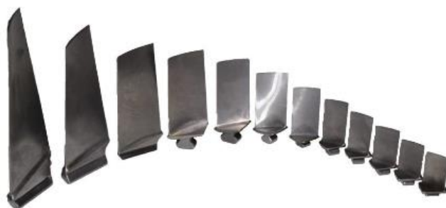
Рис.4. Лопатки компрессора ГТД ТВ3-117.
