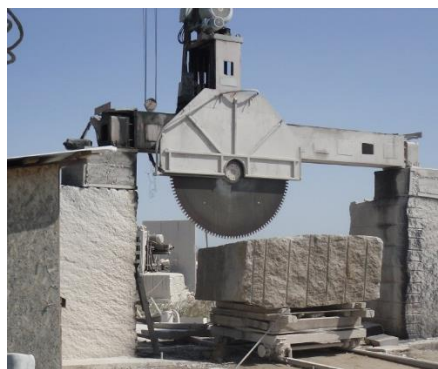
Рис. 1. Процесс распиловки гранитного блока дисковой алмазной пилой
