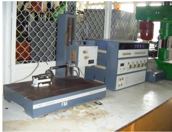
Рис. 1. Прибор для измерения шероховатости «Профилометр-профиллограф - 252»
