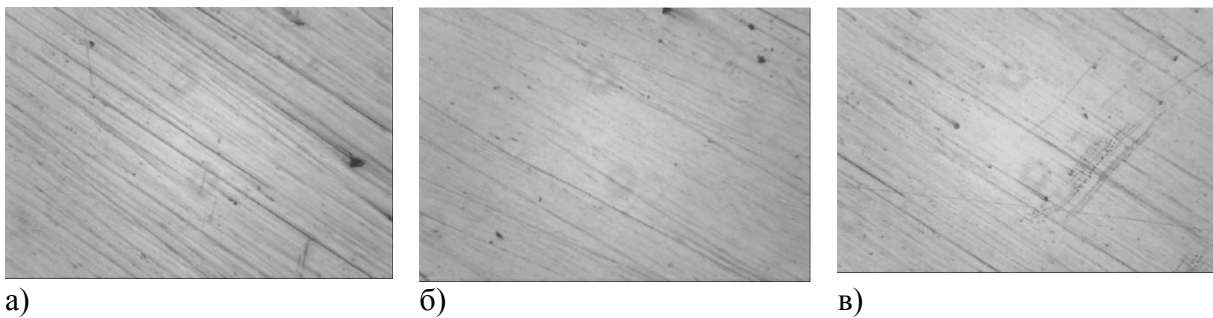
Рис. 2. Образцы поверхностей ( \times 200 ): а - после предварительного полирования, б - чистового полирования, в - полирования и глянцеваания
