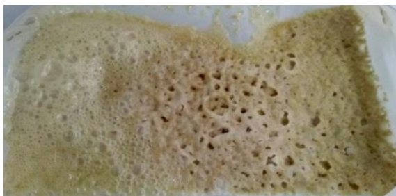
Рис. 9. Состояние отходов ЭДТ-10П и УП-2217 в присутствии крахмала и кислоты H_3PO_4
