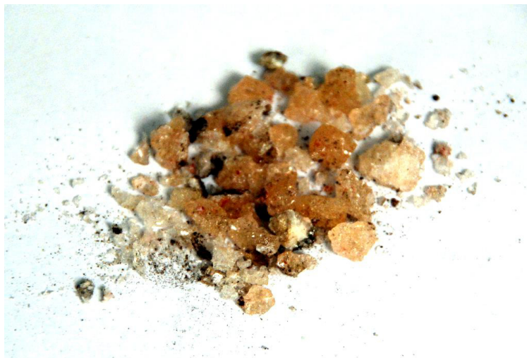
Рис.2. Внешний вид смолы ЭД-22 после отверждения H3PO4
