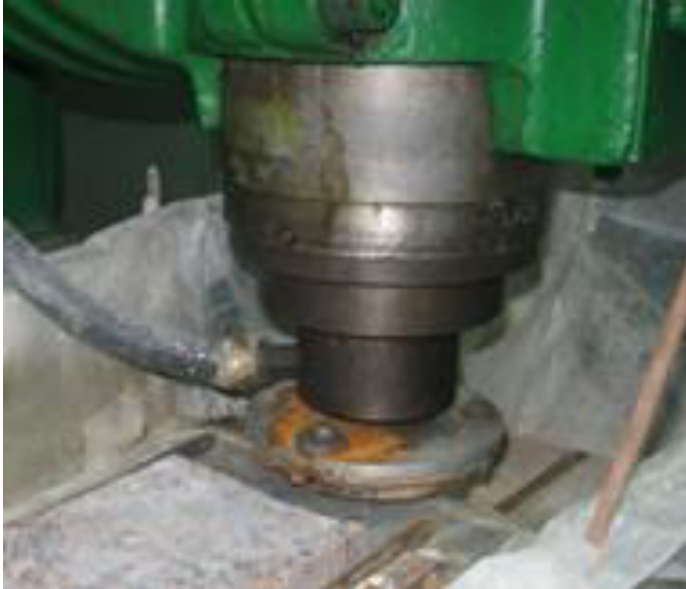
Рис.3. Вид специальной головки для установки торцевого шлифовального инструмента и подачи СОЖ
