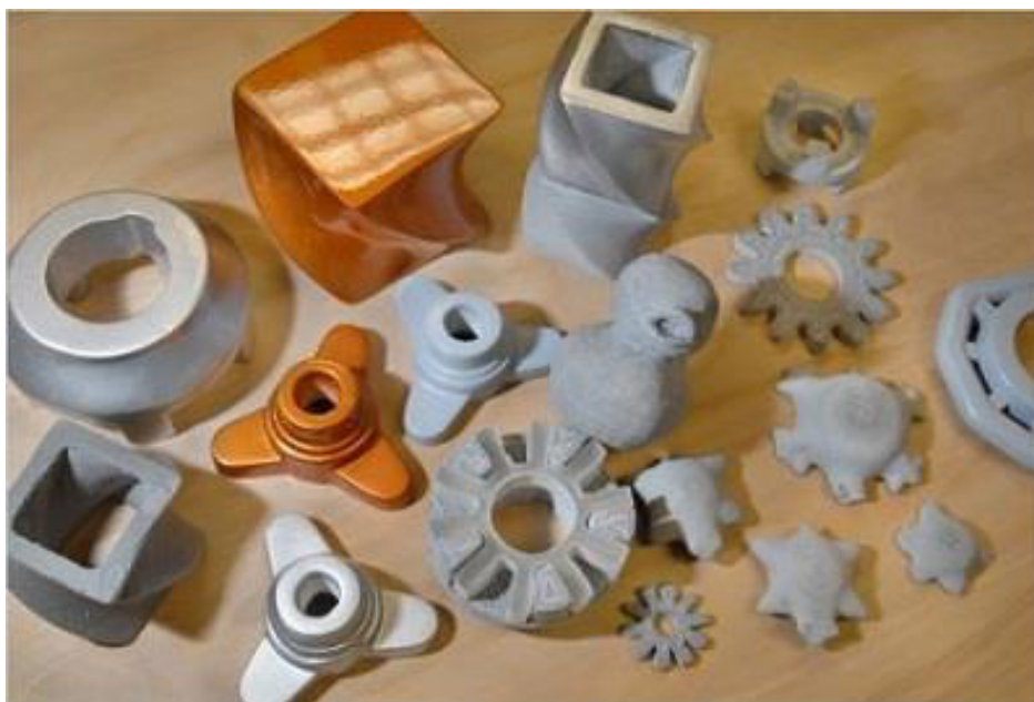
Рис. 2. Детали для тестирования, созданные 3D принтером.
