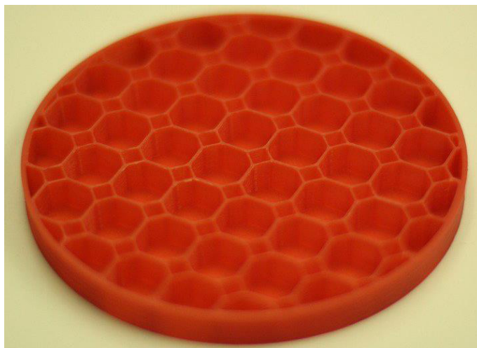
Рис. 1. Сотовая структура заполнения детали
