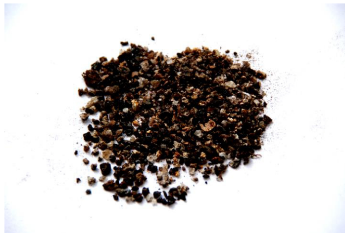
Рис.4. Внешний вид смеси отвержденных смол (ЭД-22+КДА) после биоразложения.
