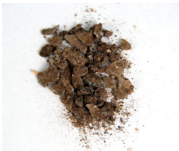
Рис.2. Внешний вид смолы ЭД-22 после отверждения H3PO4
