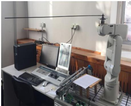
Рис.3 – Экспериментальный стенд для исследования вращения стержня
