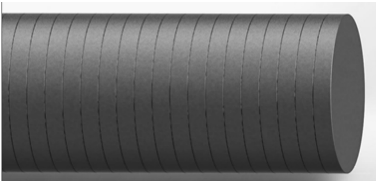
Рис. 3. Канавки от «выстоя» резца на поверхности вала
