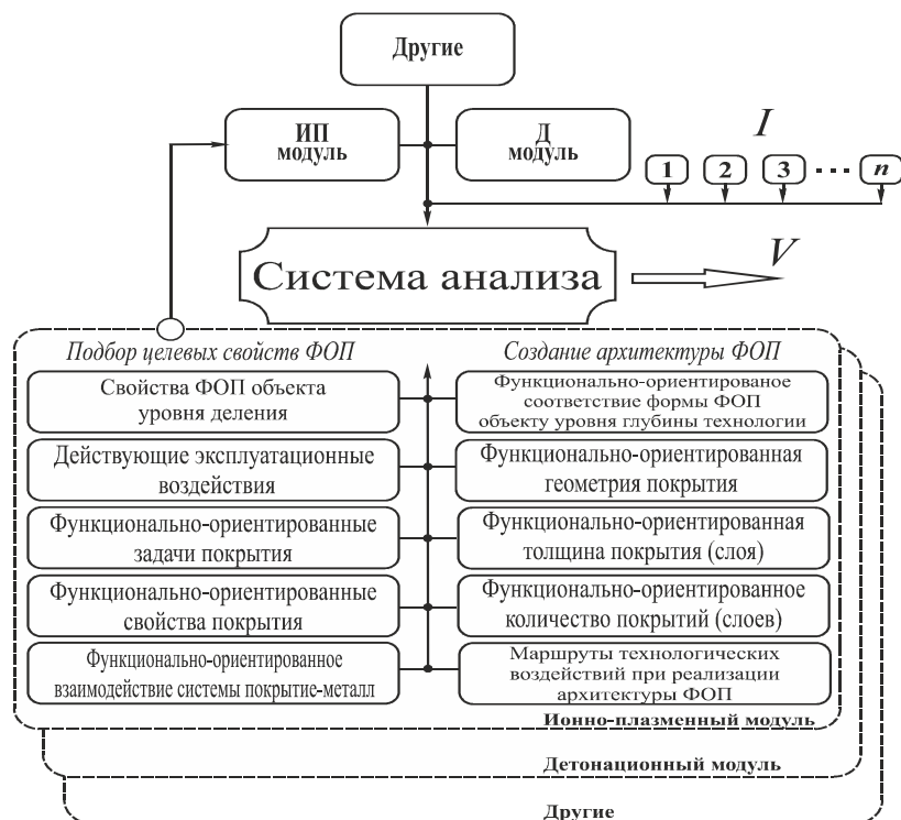
Рис. 3. Основные параметры, участвующие в функционально-ориентированном проектировании ФОП
